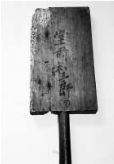
図4 木型職人の名 堂前 松三郎 落雁No.9木型 幅 2.7cm 長さ24.4cm 持手 長さ9.7cm 直径 2.5cm 桂の木
